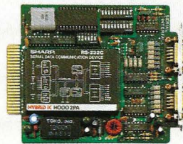
RS-232Cシリアルインターフェイスカード MZ-8BI03 標準価格 50,000円
